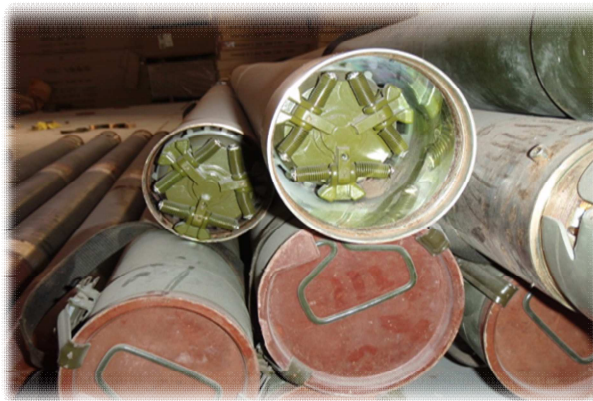
صاروخ زرع ألغام عيار 122-15 ATML MINE ROCKET TYPE 122-15 ATML showing mines inside
